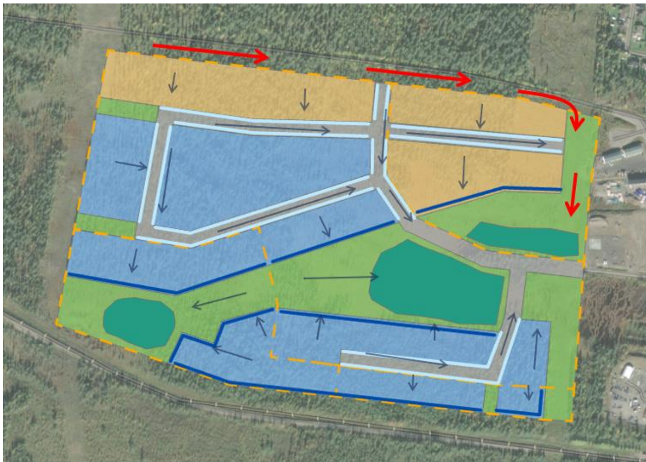
Figur 14. Principskiss över föreslagen dagvattenhantering samt skyfallsavledning av naturmark mellan planområdet och vägen precis norr om planområdet.
