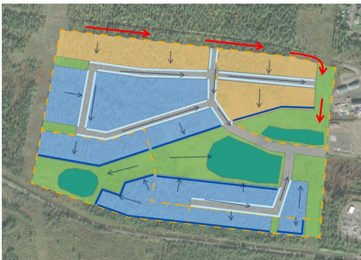
Figur 14. Föreslagen dagvattenhantering och avrinningsvägar. Ljusblå streck visar dike i anslutning till gata och mörkblå streck föreslagna diken i bakkant av fastighetsmark. Föreslagna ytor för fördröjning markerade med blågrönt (Norconsult, 2025a).
