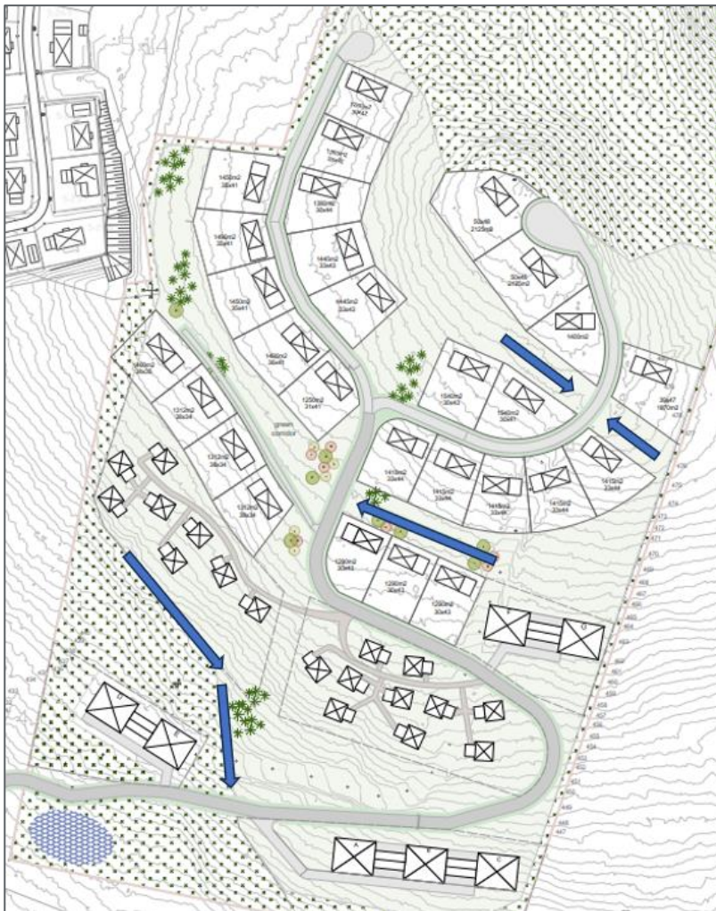
Figur 18. Områden där mindre avskärande diken kan behövas för att hindra avrinning mot byggnation och styra flöden mot vägnätet och vidare nedströms.
