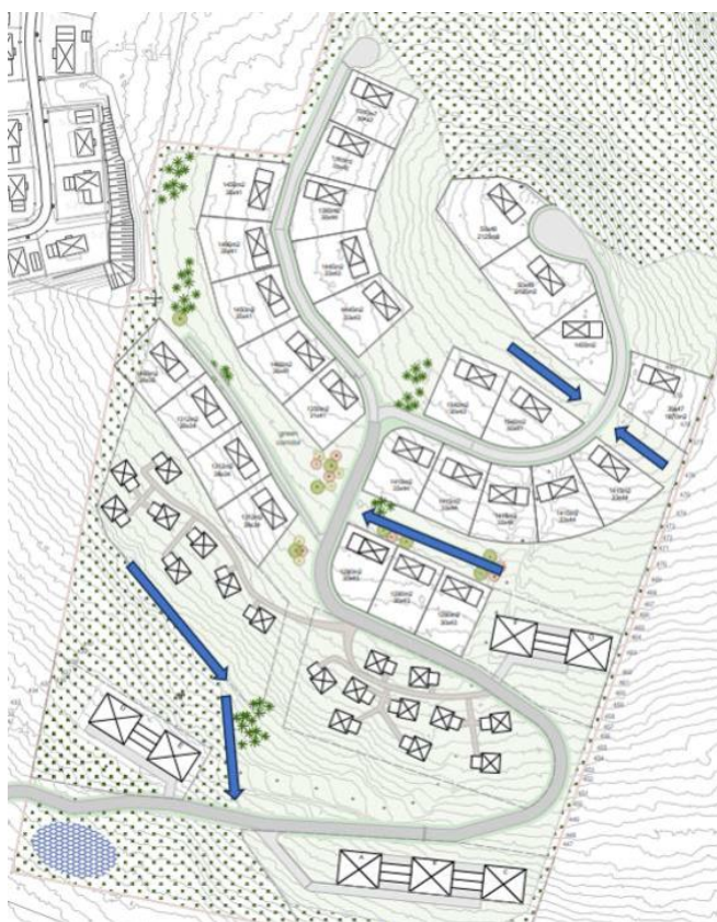
Figur 18 Figur till vänster visar flödesvägar inom och runt planområdet. Pilar visar flödesriktning. Blå ytor visar områden där vatten potentiellt kan bli stående under skyfall. Figur till höger visar områden där mindre avskärande diken kan behövas för att hindra avrinning mot byggnation och styra flöden mot vägnätet och vidare nedströms.
