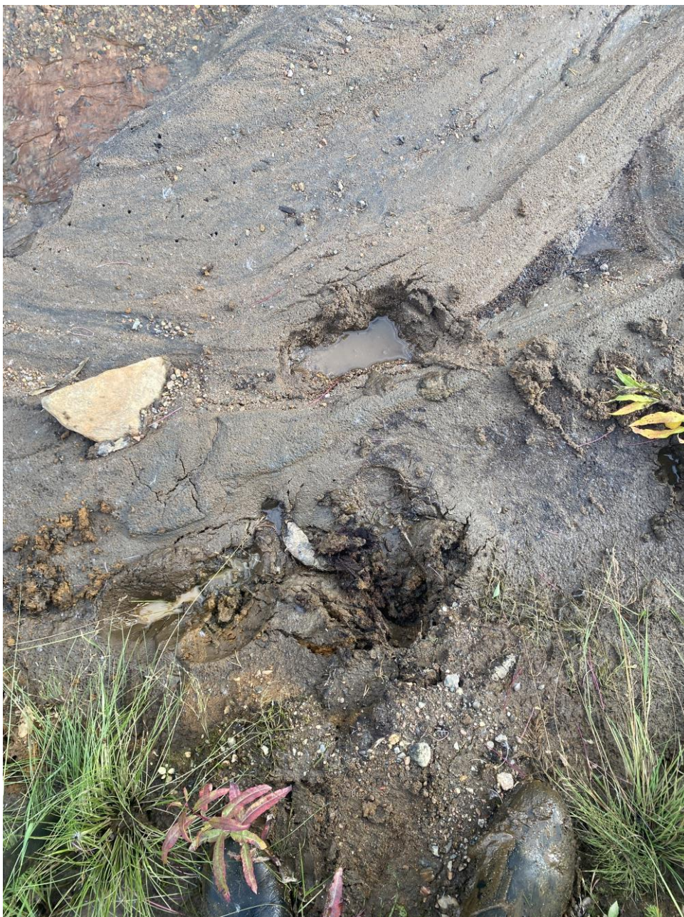
Figur 2. Massor är mjuka. Notera fotspår till ca 0,15 meters djup. IMG_7118.jpg
