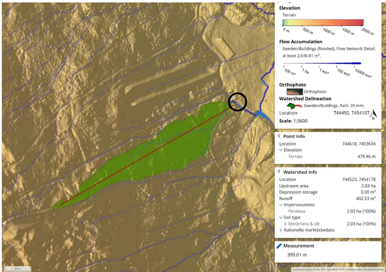
Figur 9. Avrinningsområde (2,03 Ha) för markerad punkt i skidbacke 1. Vald höjdprofil (Röd linje) motsvarar de nedre delarna av Transekt B i Figur 2. Se Figur 10.
