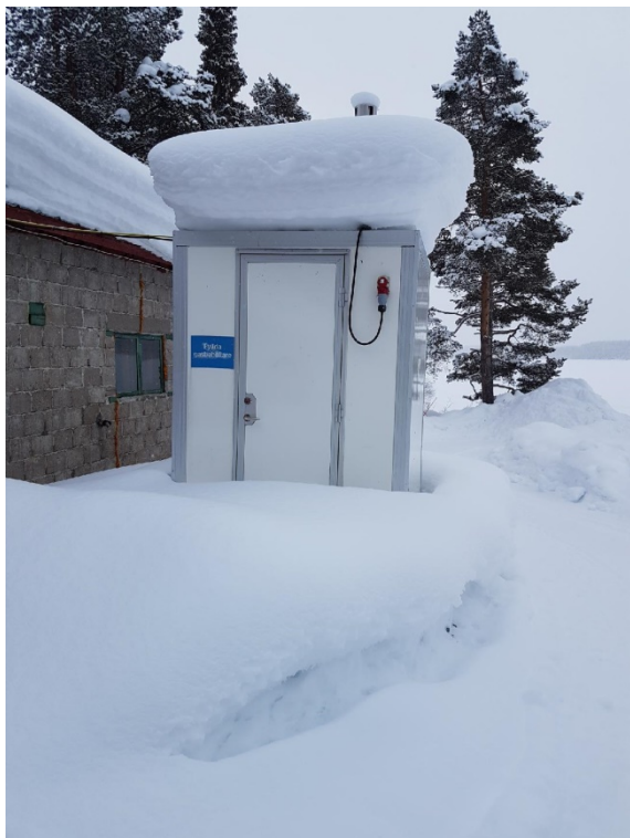
Figur 5. Mätbod för optisk mätning av partiklar i luft.
