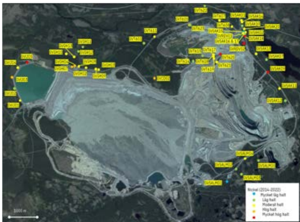
Figur 8.8. Nickel i grundvatten (2014-2022). Provpunkternas färg visar på klassificering enligt SGUs bedömningsgrunder.
