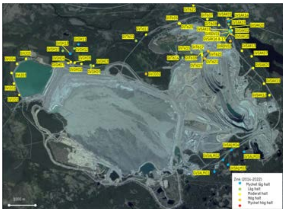
Figur 8.9. Zink i grundvatten (2014-2022). Provpunkternas färg visar på klassificering enligt SGUs bedömningsgrunder.
