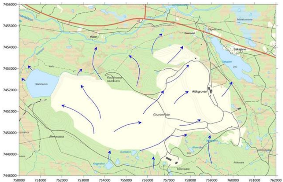
Figur 33. Grundvattnets flödesmönster i jord, översiktligt illustrerat. Bakgrundskarta: © Lantmäteriet (2021). Kartproducent: Boliden Mineral AB.
